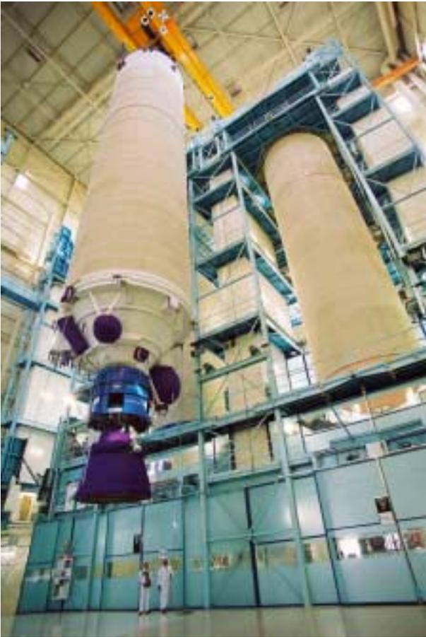
Opérations de sortie de dock d'intégration, de basculement et de mise en container de transport de l' Etage Principal Cryotechnique ARIANE 5 aux Mureaux
